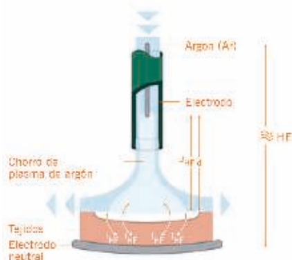
Principio operativo para la Coagulación de Argón Plasma
