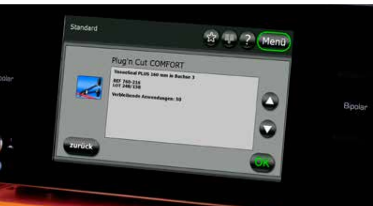
Plug'n Cut COMFORT: Das COMFORT-SYSTEM erkennt automatisch das COMFORT-Instrument, gibt an, für wie viele Einsätze es noch verwendet werden darf, und wählt die richtigen Parameter für den Einsatzzweck vor
