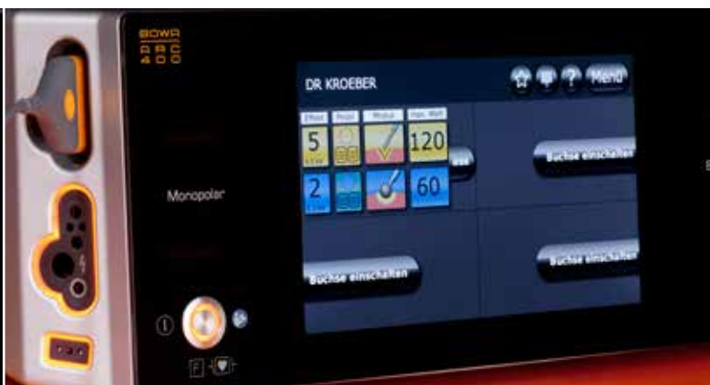
Plug'n Cut: Der ARC 400 erkennt automatisch, dass ein Standard-Instrument angeschlossen ist, z. B. bei der Verwendung von vorhandenem konventionellem Zubehör
